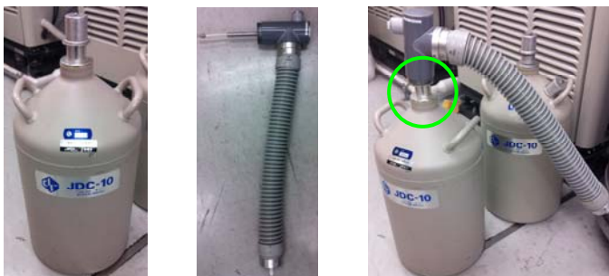
デュワー瓶 デュワーヒーター 接続した状態
